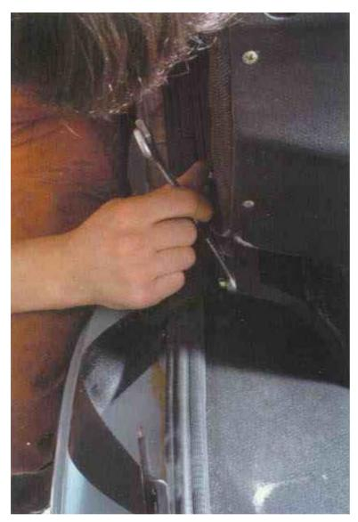
Отвинчиваем верхнюю (на стойке) и нижнюю (у порога) направляющие скобы, и затем уже свободно продеваем ремень через отверстие в боковине полки
