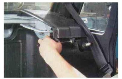
Снимаем боковины. Каждая из них крепится к кузову двумя винтами и одним пистоном.
