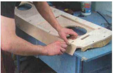
Окончательное крепление планки начинаем с того, что прихватываем ее сначала двумя крупными шурупами по сторонам, и лишь затем привинчиваем небольшими саморезами и скрепляем при помощи степлера скрепками по всему периметру.
