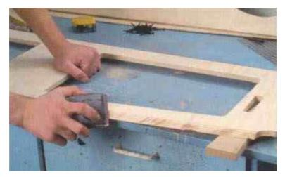
Угол скашиваем лобзиком - так и точнее, и намного быстрее, а затем тщательно обрабатываем поверхность, сглаживая ее, а в конце обязательно зашлифовываем шкуркой.
