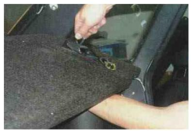
Через подготовленное отверстие пропускаем ремень и закрепляем его вверху на стойке и внизу у порога.
