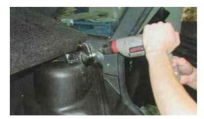
Установ ив полку, уже по месту просверливаем отверстие под саморез (старое крепление не подходит).
