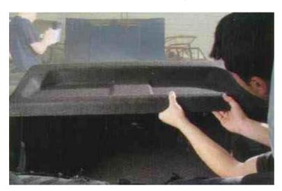
Сложите заднее сиденье, отверткой аккуратно вытаскиваем 4 пластиковых пистона, - сначала верхние "гвоздики", потом "гофрированные" распорки.
