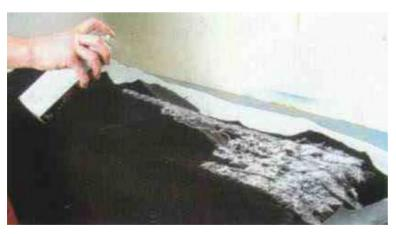
Окончательный же "штатный" вид полке придаст обивочная ворсистая ткань или карпет. Отрезав кусок с 3-4-сантиметровым запасом по каждой стороне, кладем его лицевой стороной на поверхность покрытую чистым полиэтиленом и равномерно покрываем клеем из баллончика (в нашем случае это "357").
