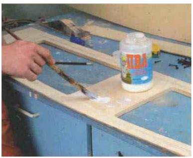
Собираем детали полки, проклеивая для прочности все скрепляемые поверхности клеем ПВА.
