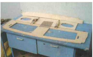
По прилагаемым выкройкам выпиливаем заготовки для полки: основную (верхнюю) часть, декоративную (с помощью которой создается подобие штатной задней полки), прилегающую к стеклу планку из тонкой фанеры, боковые подпорки (их лучше в сего сделать наборными из той же фанеры) и решетки.
