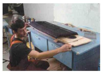
Вычисляем угол, который должен быть между полкой и планкой, для чего прикладываем штатную полку так, как показано на фото. Для 21099 он должен составлять около  $50^{\circ}$ .
