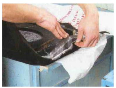
Тщательно проклеив края, заворачиваем внутрь все концы и, максимально натягивая карпет, закрепляем, где нужно, концы скрепками.
